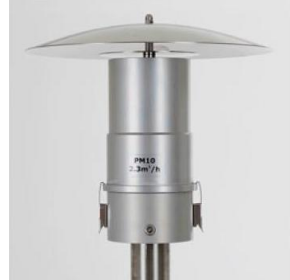
Семплери за измерване концентрациите на ФПЧ2.5 и ФПЧ10
